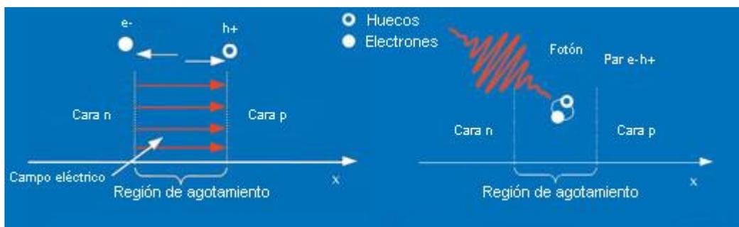
Figura 9. Generación de corriente eléctrica en la interfaz de la unión p-n. Fuente: García-García et al., (2012).
