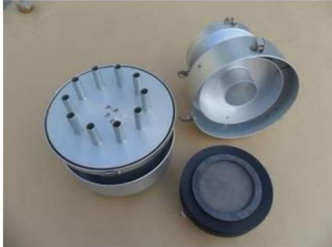
**Figura 2.3.** Ejemplo de captador de alto volumen con cabezal adaptado para PM10 según la norma UNE-EN 12341. No corresponde a la imagen anterior, es otro modelo. Fuente: MCV.
