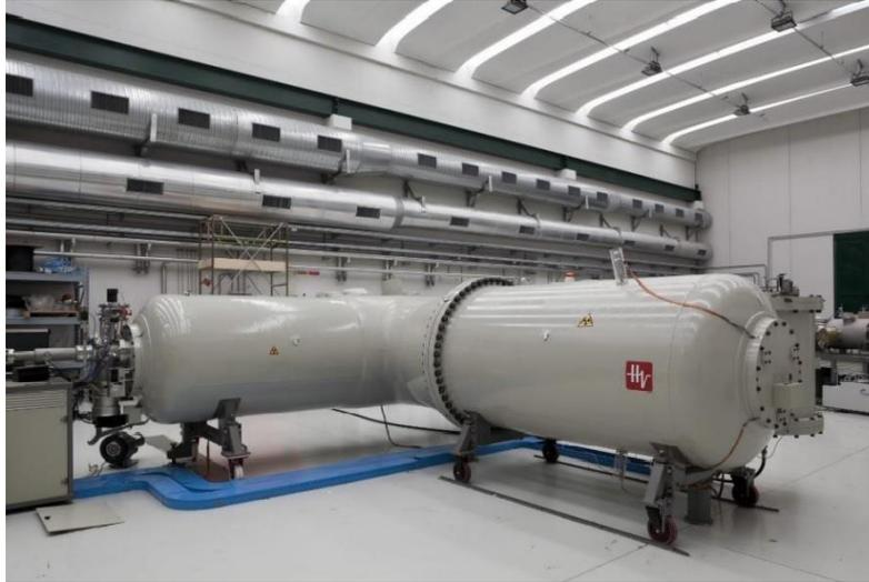
**Figura 2.6.** Acelerador Tandetrón 3MV del laboratorio de haz de iones INFN LABEC en Florencia. Fuente: IonBeamCenters.eu INFN.
