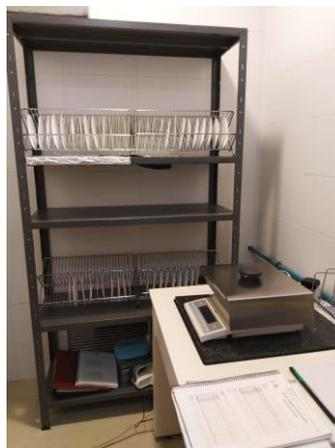
**Figura 7.** Se muestra la sala de balanzas donde se realiza el acondicionamiento y el pesado de los filtros.
