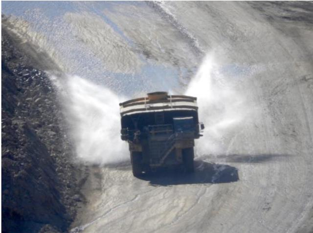
Figura 46. Dumper de riego. Fuente: [Atalaya Riotinto Minera, S.L.U.](#)
