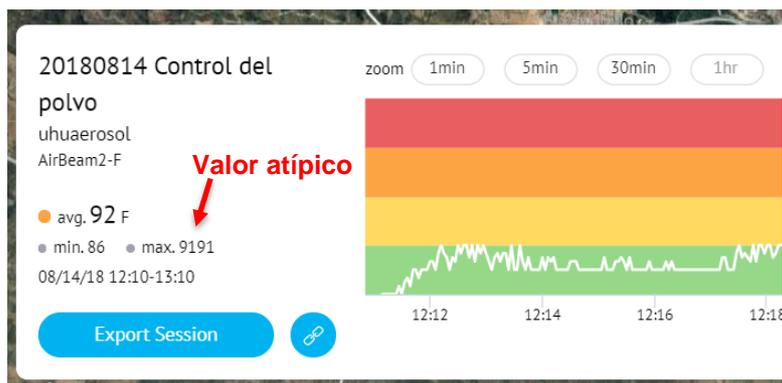
Figura 53. Valor atípico en la plataforma AirCasting.
