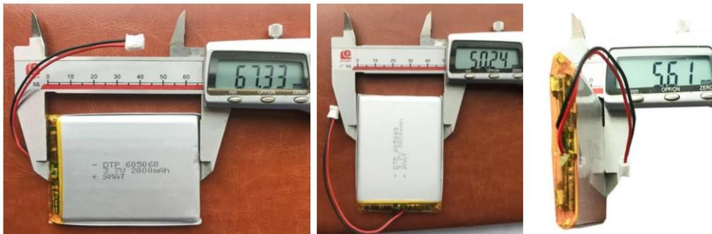
**Figura A14.** Batería DTP 605068 con las dimensiones en mm.
