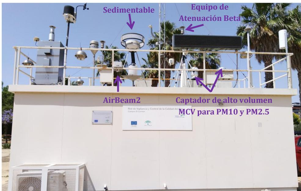
Figura 12. Estación completa.
