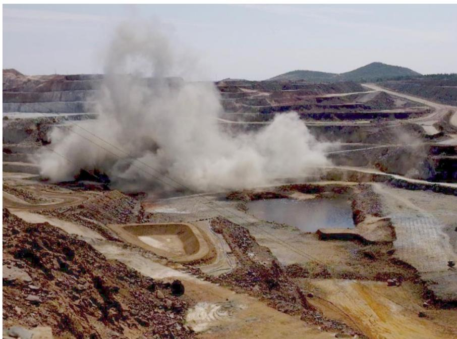
**Figura 3.** Emisiones de polvo generadas durante una voladura. Fuente: Mina de Riotinto.
