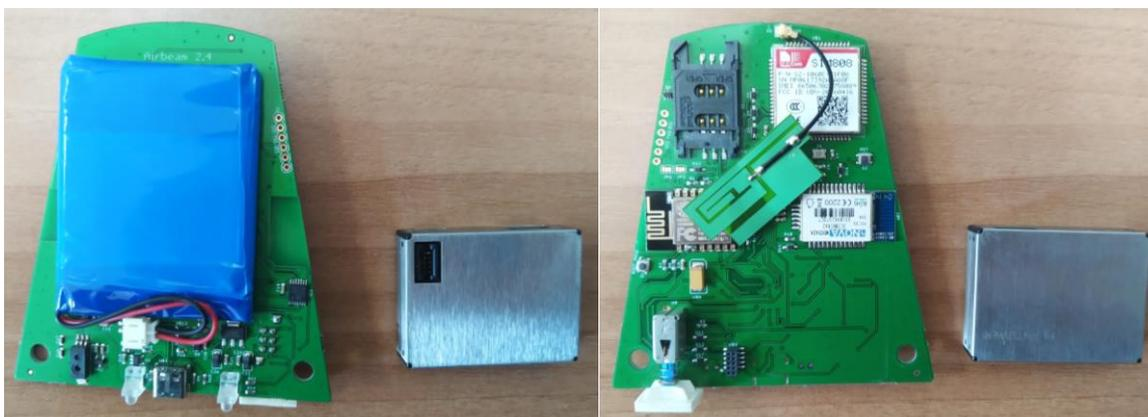
**Figura A20.** Montaje del AirBeam2 junto con el sensor de PM.
