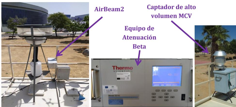
Figura 11. Equipos de la estación.
