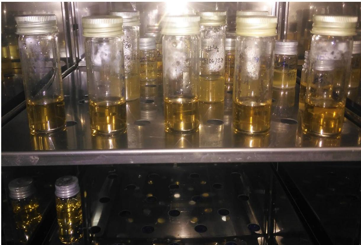
**Figura n.º1:** Detalle de incubación de las superficies de ensayo, en medio de cultivo líquido (TSB), en frasco de McCartney. Foto: El autor.
