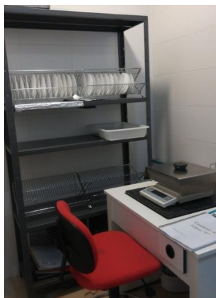
Figura 3.6.- Detalle interior sala de pesada y balanza Sartorius.
