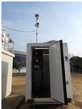
Figura 1.10.- Equipo Xact 625i en unidad transportable. En la parte superior se sitúa el cabezal de corte y entrada al equipo situado en un rack.
