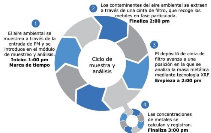
Figura 1.12.- Esquema de etapas de muestreo y análisis químico de PM mediante Xact 625i.
