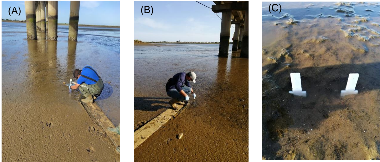
Figura 6. (A) Inserción de tubo PVC para colecta de réplica de sedimentos; (B) Inserción manual de DGT en sedimentos; (C) Muestreadores pasivos tipo DGT colocados en sedimentos.
