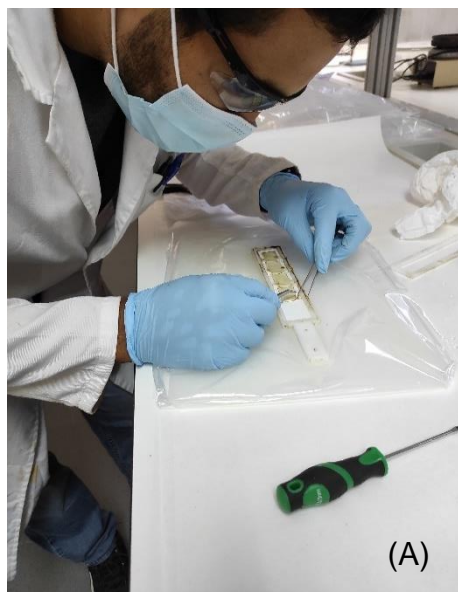
Figura 9. (A) Seccionado y extracción de resina de cada DGT; (B) Adición de ácido acético 0.11M a sedimentos
