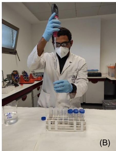
Figura 9. (A) Seccionado y extracción de resina de cada DGT; (B) Adición de ácido acético 0.11M a sedimentos
