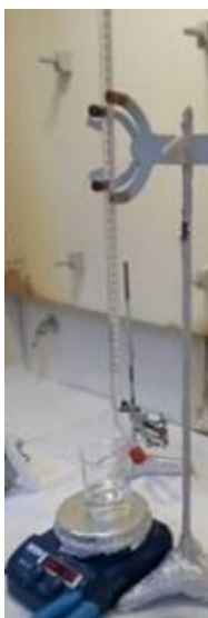
Figura A2. Dispositivo experimental llevado a cabo para la valoración del RT con AM y con NaOH (0.1 M).
