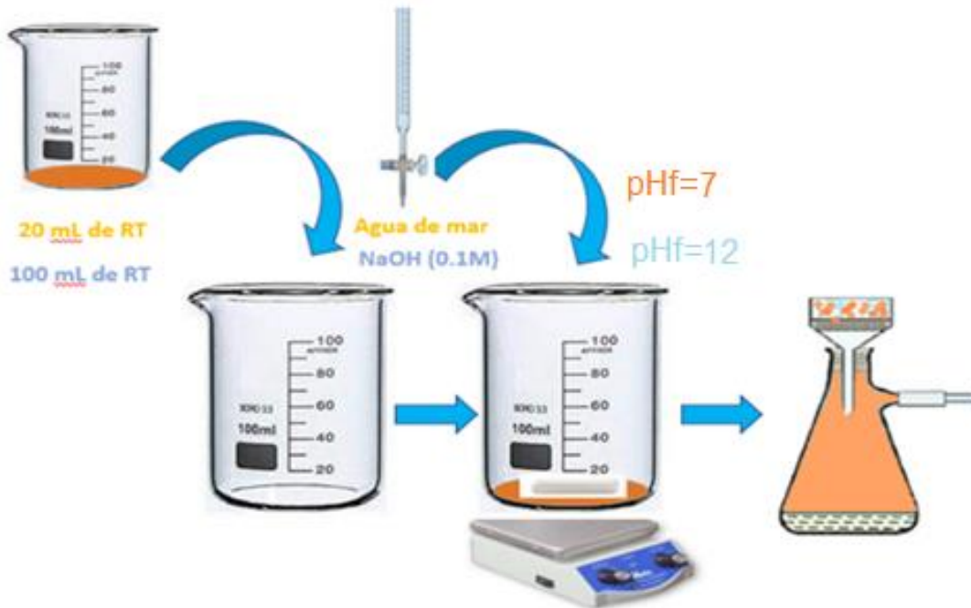
Figura 4. Esquema del proceso de neutralización con agua de mar y con NaOH (0.1 M).
