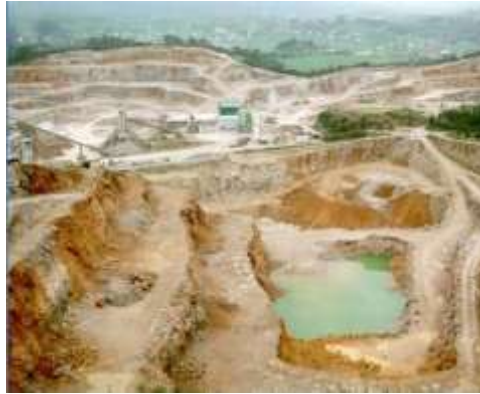
Figura 9. Cantera de rocas industrial, calizas para áridos de machaqueo en Camargo, Cantabria. Fuente: guía para la rehabilitación de huecos mineros con residuos de la construcción y la demolición (RCD), Ministerio para la Transición Ecológica (2018)
