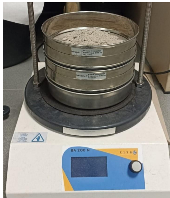
Figura 5. Tamizadora electromagnética CISA BA 200N.
