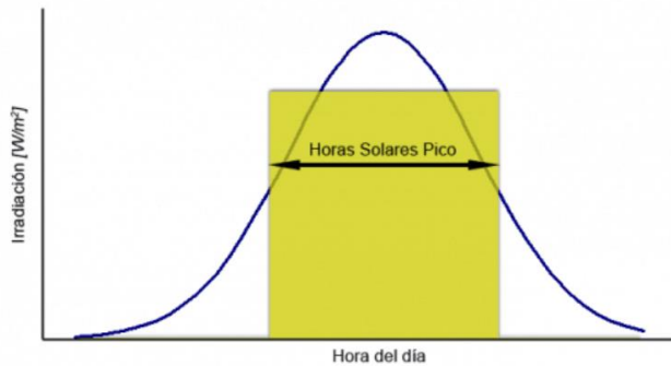
Figura 2. Horas de sol pico para la generación de energía eléctrica. Fuente: Sfe-Solar.
