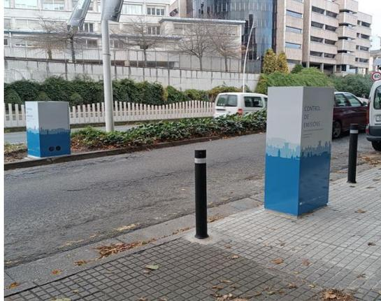
**Figura 33.** Medidores de emisiones en continuo dentro del interior de la ZBE de A Coruña. Fuente: [Concello de A Coruña, 2022](#).
