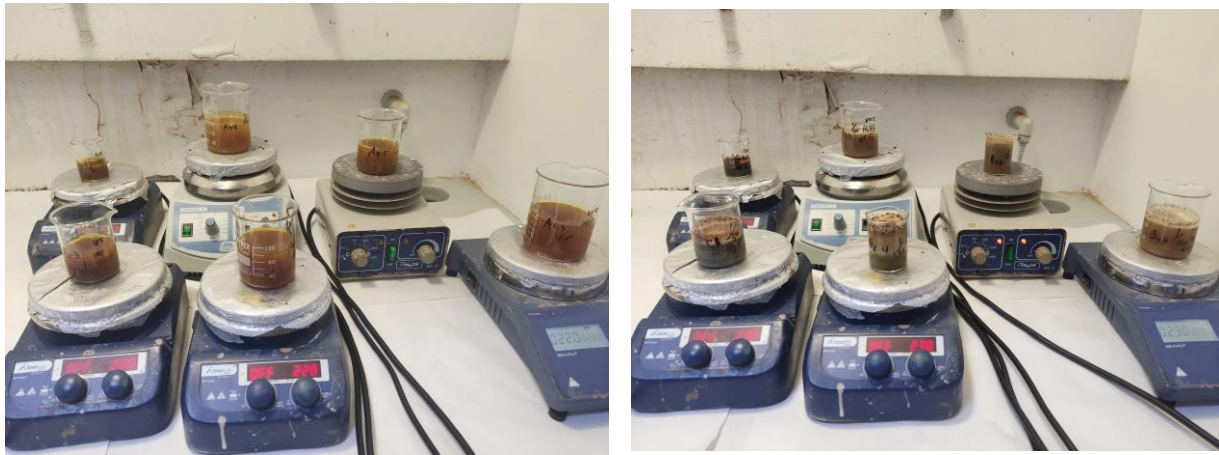
Figura 2.3. Lixiviaciones realizadas con ácido clorhídrico (izquierda) y ácido sulfúrico (derecha).
