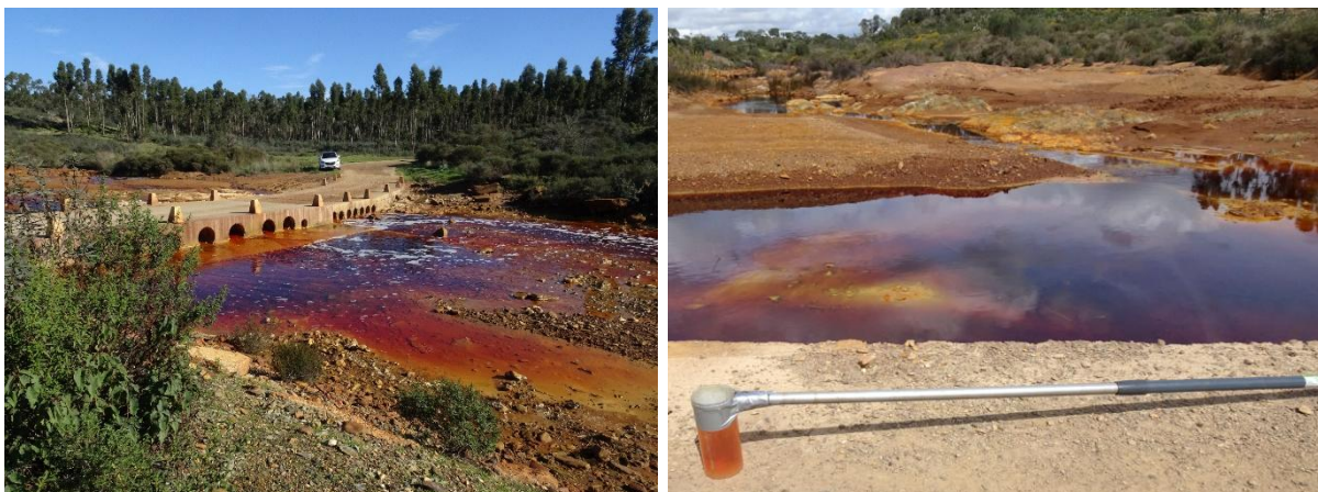
Figura 6. Zona de muestreo y pértiga usada para recoger las muestras de agua.
