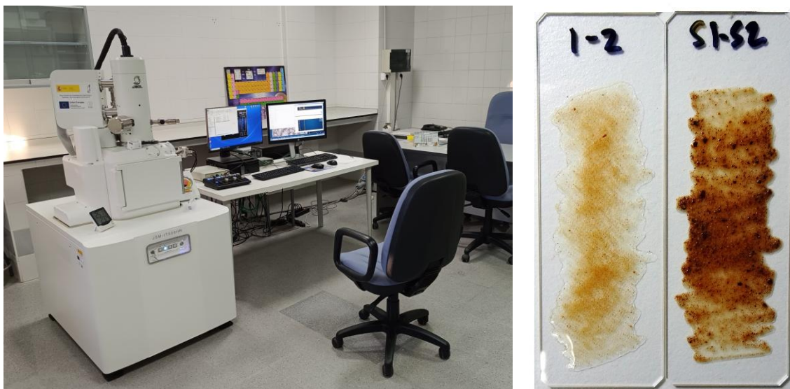
Figura 10. Microscopio SEM-EDS (izquierda) y muestras de precipitados (derecha)
