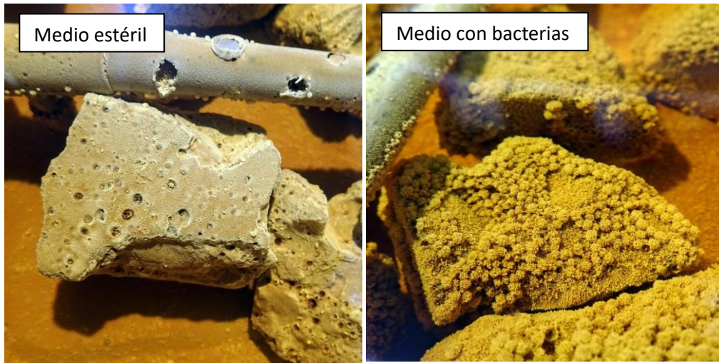
Figura 33. A la izquierda, pieza de hormigón en medio estéril; a la derecha, en medio con bacterias.
