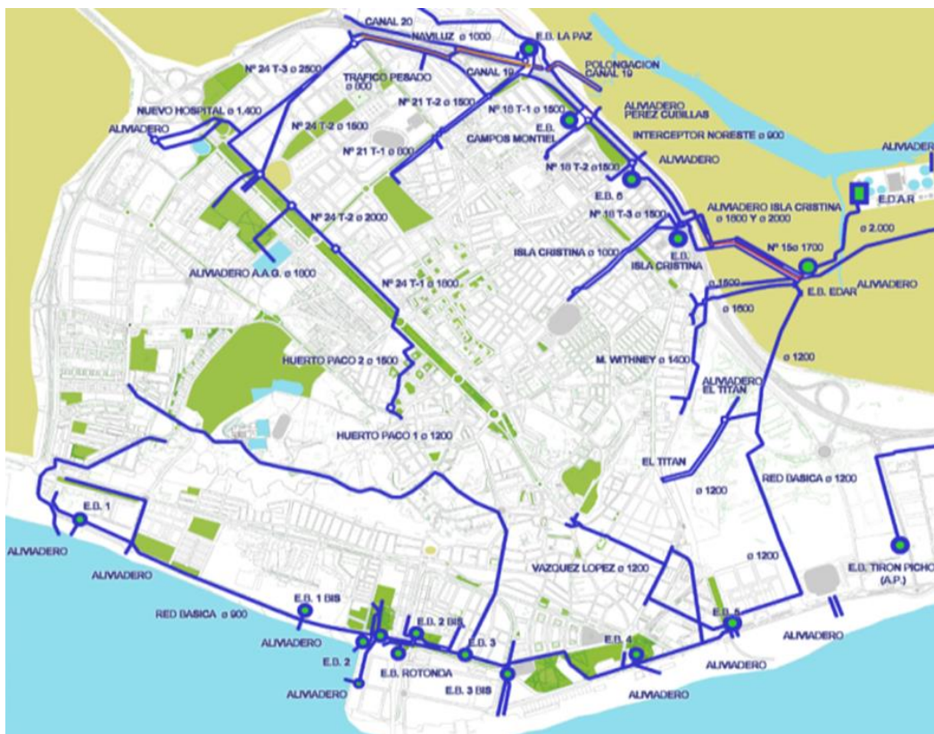
Figura 6: Red de Saneamiento. (Aguas de Huelva, datos 2023).
