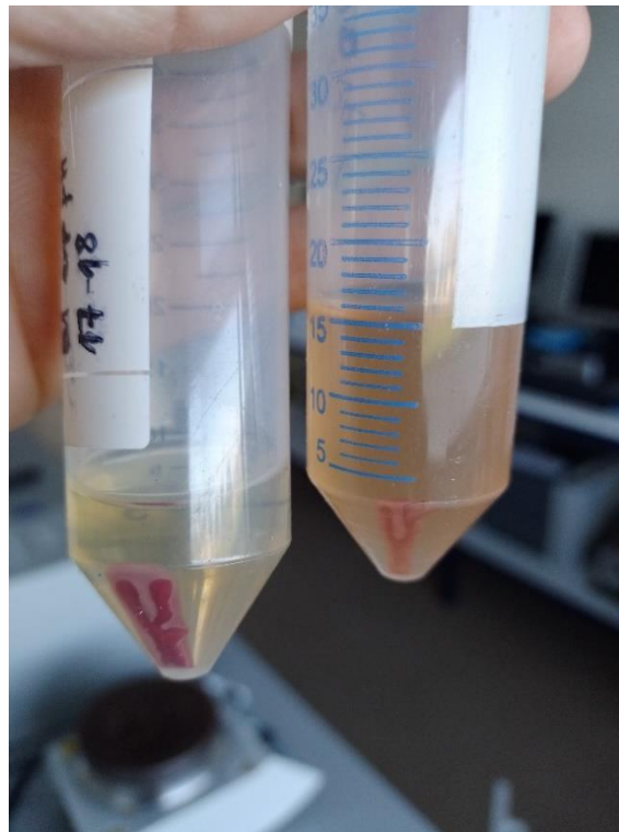
Figura 2.4. Ejemplo de la optimización de la centrifugación de Halorubrum sp. Vial izquierdo , muestra correctamente centrifugada. Vial derecho , otras pruebas de centrifugación, donde el sobrenadante continúa con color rojizo tras la rotura celular.
