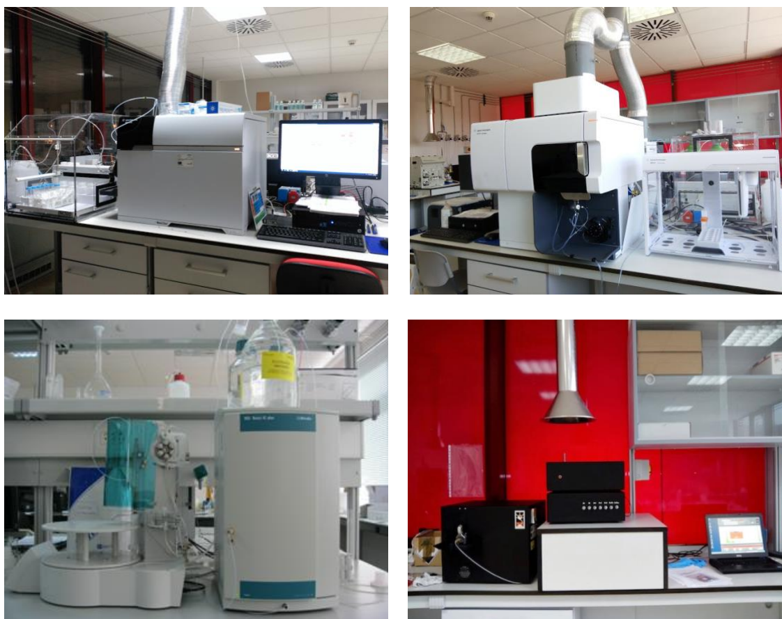
Figura 4. Instrumentación empleada en el análisis de elementos traza (ICP-MS, Agilent 7900), mayores (ICP-OES, Agilent 5110), iones (Cromatografía Iónica, 883 Basic IC plus METHROM) y especies de C (Sunset), respectivamente.
