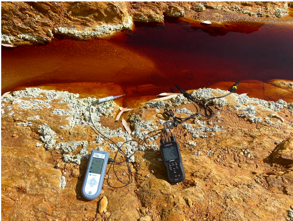
Figura 4.- Mediciones de diferentes parámetros fisicoquímicos como pH, conductividad eléctrica (CE), potencial de oxidación-reducción (ORP) y temperatura realizados in situ.
